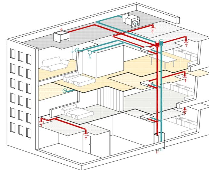
**Ventilación de las viviendas de doble flujo con recuperación de calor**
